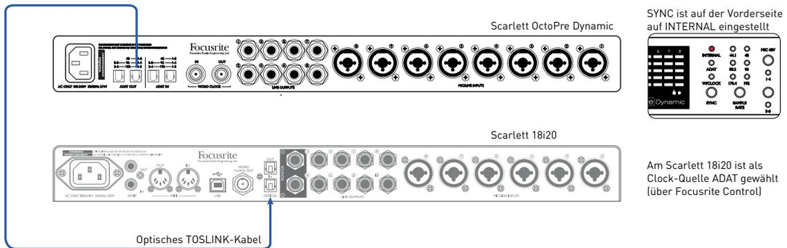
In diesem Beispiel ist der **ADAT OUT** am Scarlett OctoPre Dynamic über ein einzelnes optisches Kabel mit dem **OPTICAL IN** eines Scarlett 18i20 Audio-Interfaces verbunden. Beide Geräte arbeiten mit einer Samplingrate von 44,1 kHz. Als Clock-Quelle ist im OctoPre INTERNAL und im 18i20 (über Focusrite Control) ADAT ausgewählt. Somit synchronisiert sich das 18i20 auf den OctoPre.
