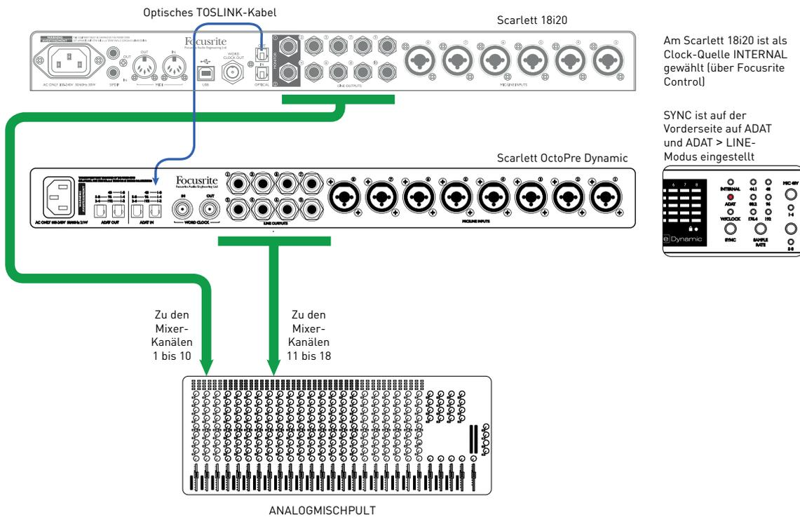
Dieses Beispiel demonstriert, wie eine große Anzahl DAW-Spuren für den Mixdown auf eine Analogkonsole gespeist werden kann. Die 10 Analogausgänge eines Scarlett 18i20 Interfaces werden mit den Mischpult-Kanälen 1 – 10 verbunden. Der Port **OPTICAL OUT** wird mit dem Port **ADAT IN** eines Scarlett OctoPre Dynamic verbunden, bei dem der Modus ADAT > LINE angewählt ist. Die **LINE OUTPUTS** des OctoPre werden dann an den Kanälen 11 bis 18 der Mischkonsole angeschlossen.
