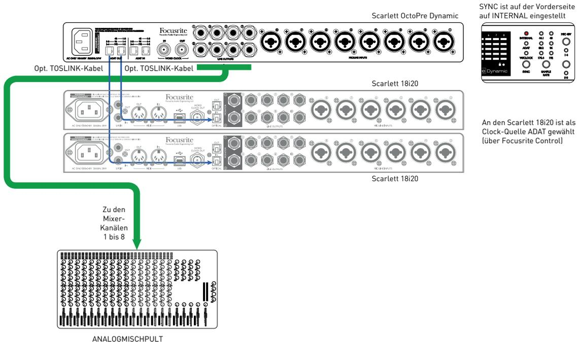
Dieses Beispiel zeigt, wie sich das Setup in Beispiel 5 erweitern lässt, um gleichzeitig eine digitale Aufnahme zu erstellen – wahlweise mit oder ohne Anlage einer Sicherung.
