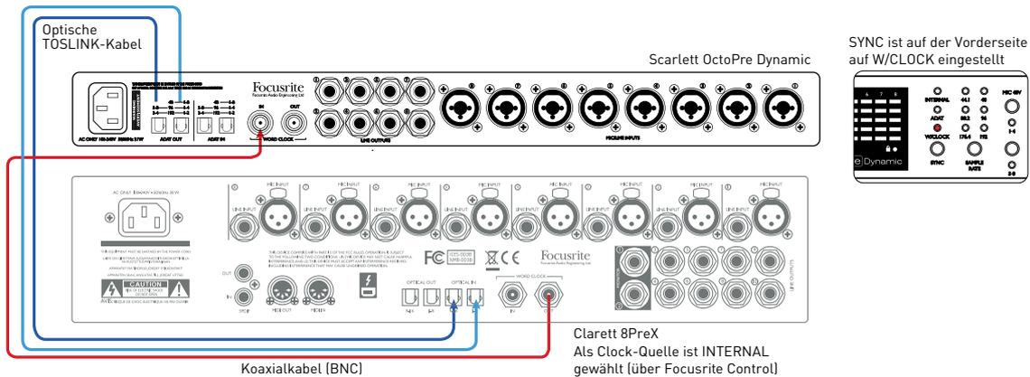
Dieses Setup entspricht im Wesentlichen dem Beispiel 2, allerdings ist in Verbindung mit einem Focusrite Clarett 8PreX auch ein Betrieb mit der Samplingrate 96 kHz möglich (Modus „SMUX-II“). Beide Geräte sind für 96 kHz konfiguriert und mit zwei optischen Kabeln zur Übertragung von jeweils vier Audiokanälen verbunden. Das Clarett 8PreX ist als Sync-Master konfiguriert. Dasselbe Setup kann auch mit 192 kHz Samplingrate und entsprechend zwei Audiokanälen pro Kabel umgesetzt werden.
